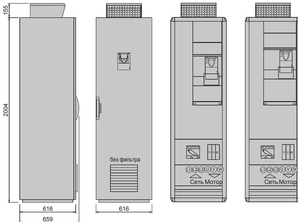
Размеры: IP 54 компактного исполнения
