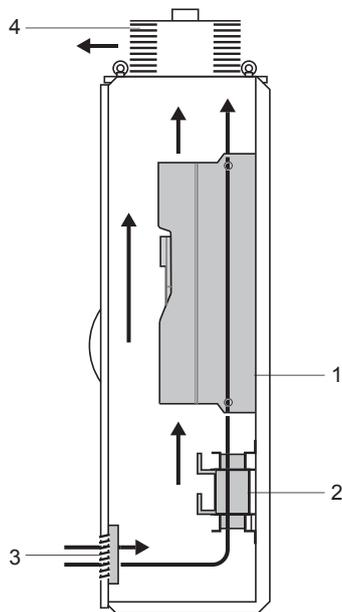
Конструкция шкафа IP54 с фильтрами предусматривает забор воздуха через решетку с фильтром в двери шкафа и выброс воздуха вытяжным вентилятором через крышу шкафа.
