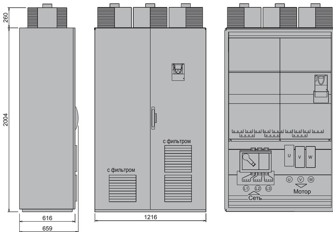
Размеры: IP54SA с отдельной системой охлаждения
