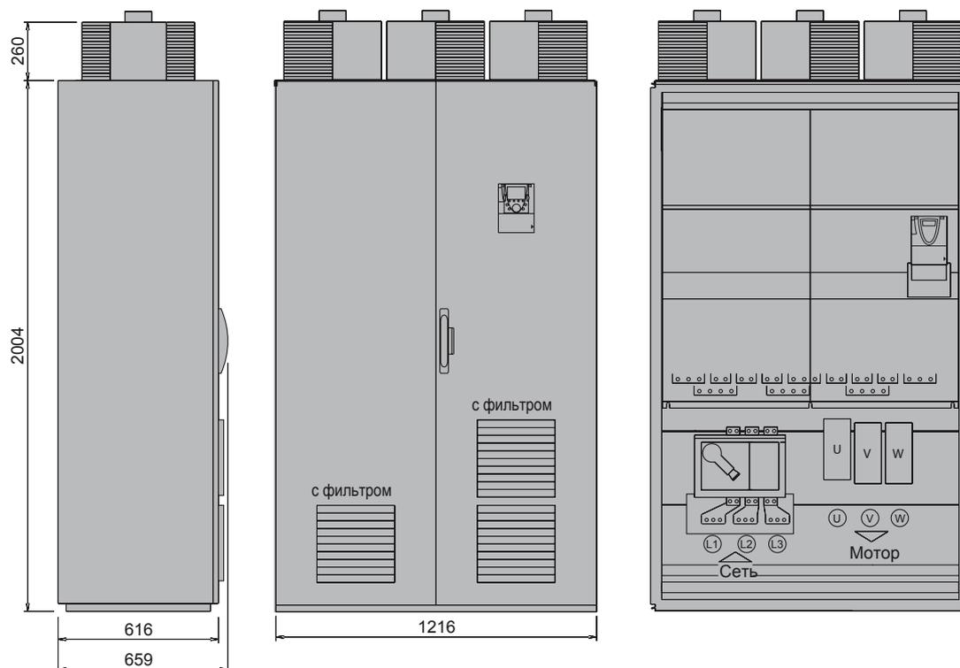
Размеры: IP54SA с отдельным контуром охлаждения
