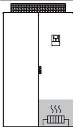
Комплект используется для обогрева шкафа против образования инея и конденсата при температур до  $-10^{\circ}\text{C}$ . Комплект состоит из обогревателя, термостата и автоматического выключателя. Комплект подключается к клеммнику X04 (макс. сечение кабеля:  $4\text{ мм}^2$ ).
