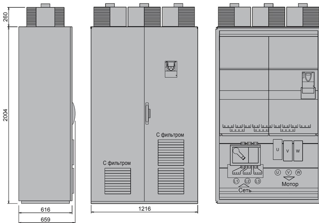
Размеры: IP54SA с раздельной системой охлаждения
