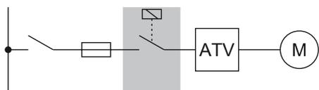
Используя контактор и функцию "line contactor control" ПЧ может включиться и отключиться от сети путем подачи команды на логический выход.
