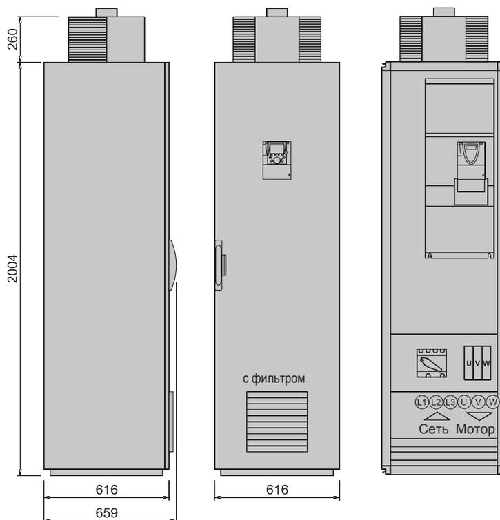
Размеры: IP54SA с отдельным контуром охлаждения
