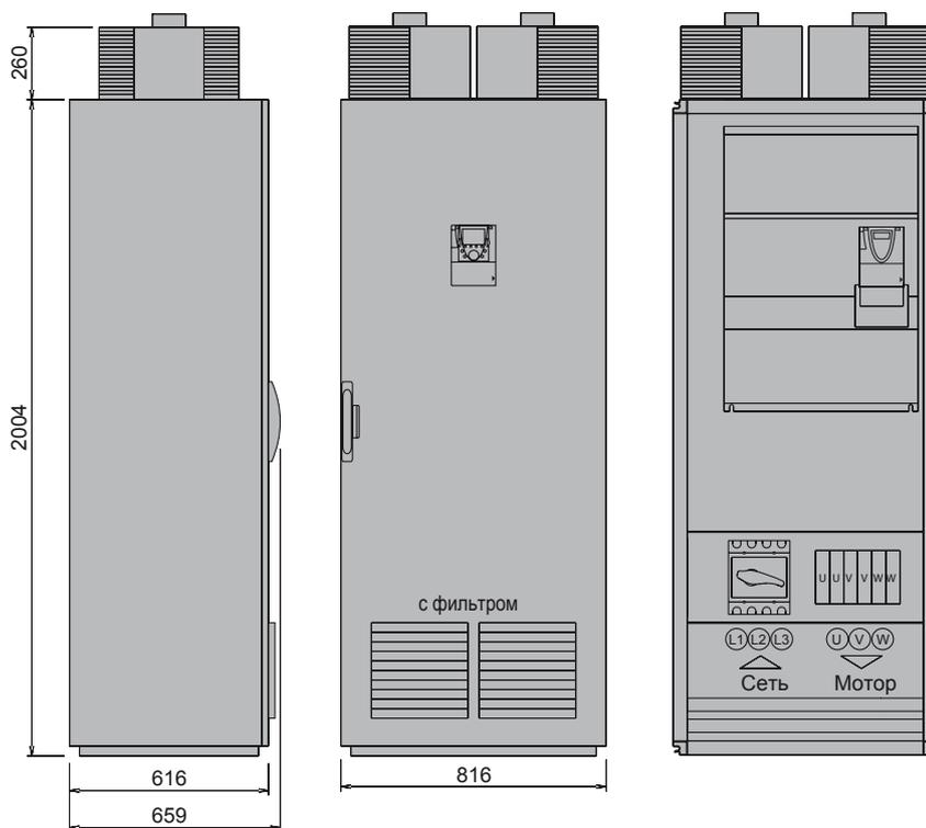
Размеры: IP54SA с раздельной системой охлаждения
