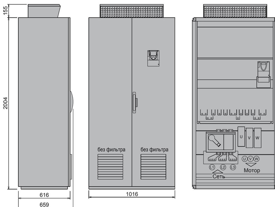
Размеры: IP54CV Компактное исполнение
