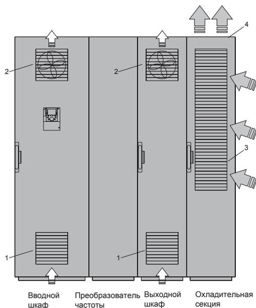
Охлаждающая секция силовой части выполнена в виде отдельного конструктива. Охлаждающий воздух всасывается вентилятором на двери шкафа и выбрасывается через решетку на крыше шкафа. Управляющая часть охлаждается вентилятором на двери шкафа.
