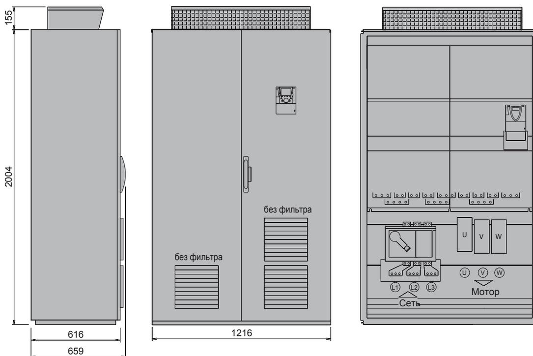
Размеры: IP54CV Компактное исполнение
