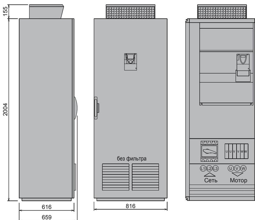
Размеры: IP54CV Компактное исполнение
