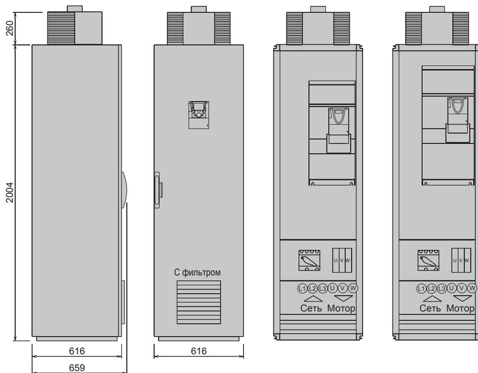
Размеры: IP 54 с отдельной системой охлаждения
