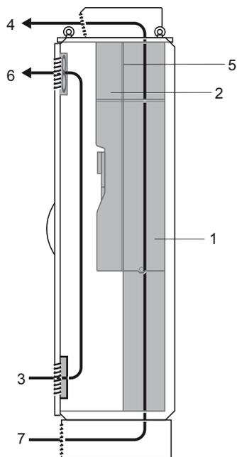
Конструкция шкафа IP54 с раздельными контурами охлаждения предусматривает забор воздуха для силовой части через цоколь шкафа и выброс через крышу шкафа. Управляющая часть охлаждается вентилятором с фильтром на двери шкафа или кондиционером (дополнительное оборудование).
