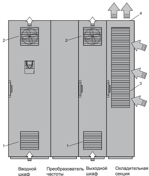
Охлаждающая секция силовой части выполнена в виде отдельного конструктива. Охлаждающий воздух всасывается вентилятором на двери шкафа и выбрасывается через решетку на крыше шкафа. Управляющая часть охлаждается вентилятором с фильтром на двери шкафа.
