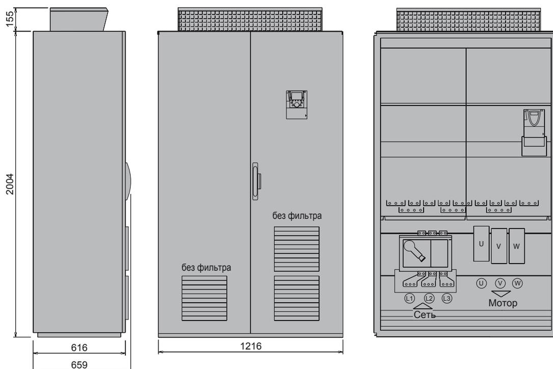
Размеры: IP54CV Компактное исполнение
