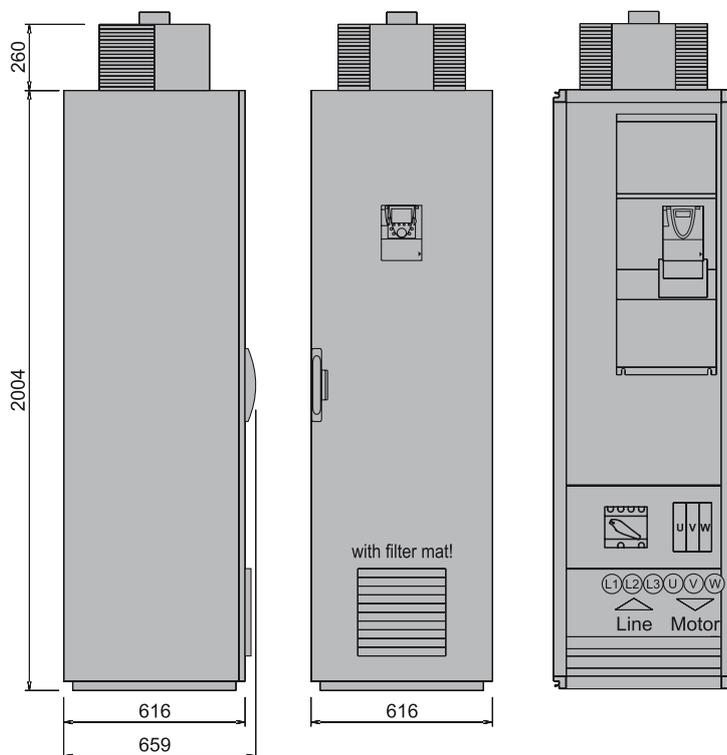
Размеры: IP54SA с отдельной системой охлаждения
