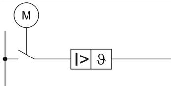
Автоматический выключатель устанавливается вместо разъединителя. Он обеспечивает безопасное отключение при перегрузках.
