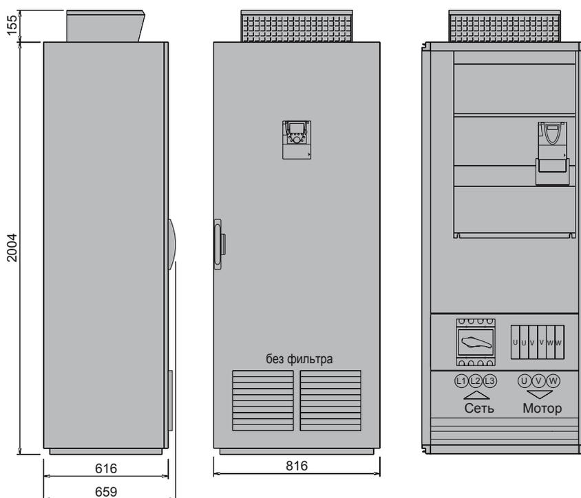
Размеры: IP54CV Компактная версия
