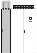
Данная опция позволяет выполнить подключение кабелей двигателя и сетевого питания через верх шкафа.
