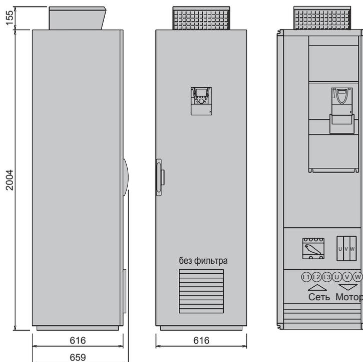
Размеры: IP54CV Компактное исполнение
