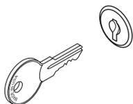
Переключатель состоит из личинки замка встроенной в дверь шкафа, которая переключает местный и дистанционный (терминал или коммуникационный порт) режимы управления. Местное управление возможно с графического терминала, который также встроен в дверь шкафа.
