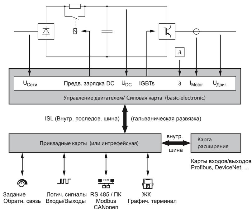
В зависимости от технических условий и требований стандартов базовый ПЧ может или должен быть укомплектован дополнительным оборудованием. В каталоге представлен широкий выбор компонентов для силовой и управляющей частей и конструктивных элементов шкафа.
