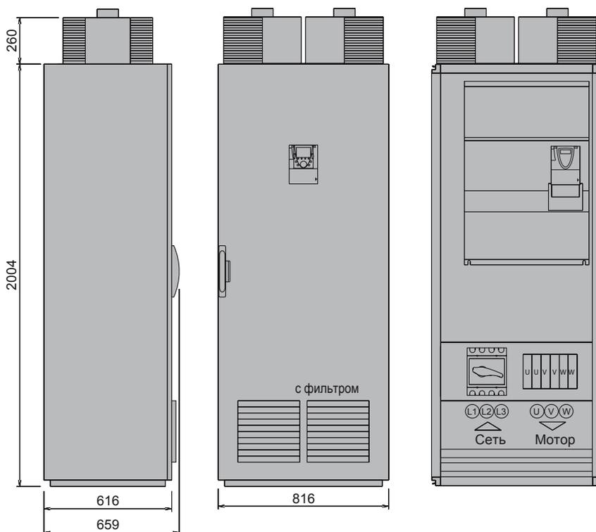
Размеры: IP54SA с отдельной системой охлаждения
