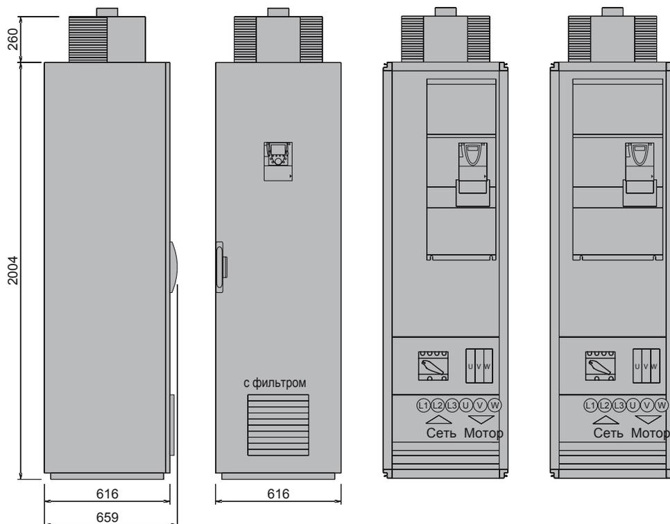
Размеры: IP54SA с отдельной системой охлаждения
