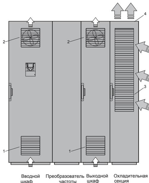
Охлаждающая секция силовой части выполнена в виде отдельного конструктива. Охлаждающий воздух всасывается вентилятором на двери шкафа и выбрасывается через решетку на крыше шкафа. Управляющая часть охлаждается вентилятором с фильтром на двери шкафа.
