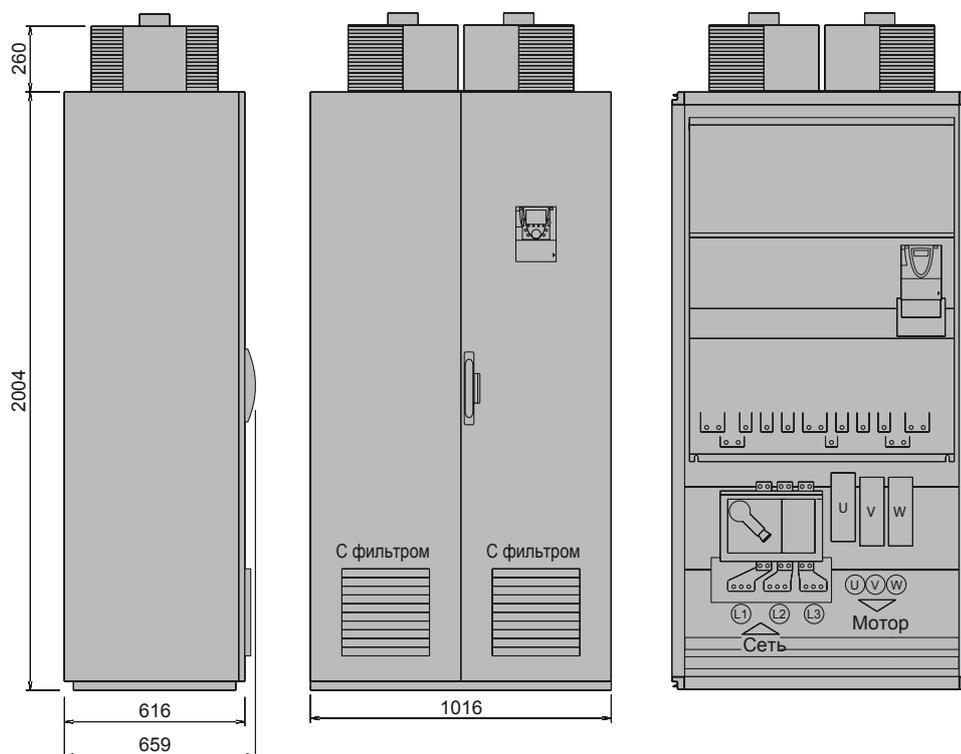
Размеры: IP54SA с раздельной системой охлаждения
