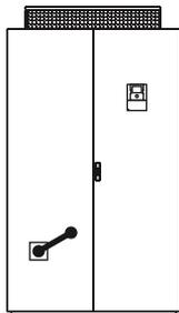
Разъединитель установлен для коммутации напряжения питания ПЧ. Внешняя рукоятка позволяет управлять разъединителем не открывая двери шкафа.
