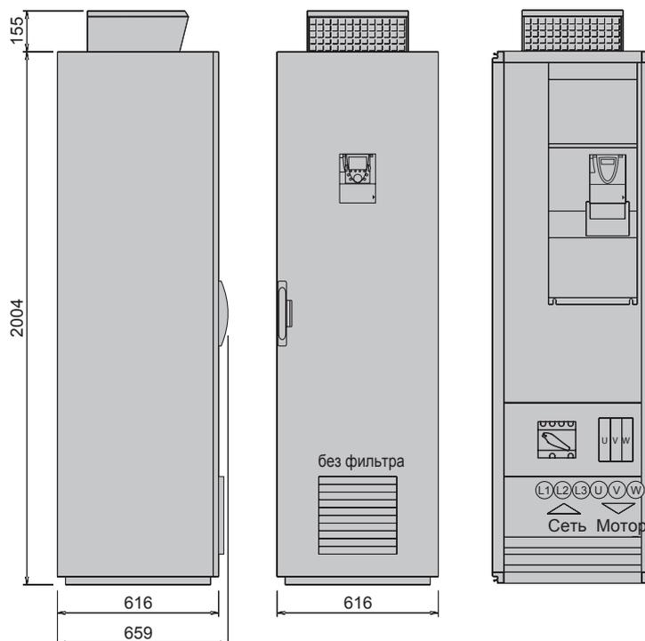
Размеры: IP54CV Компактное исполнение
