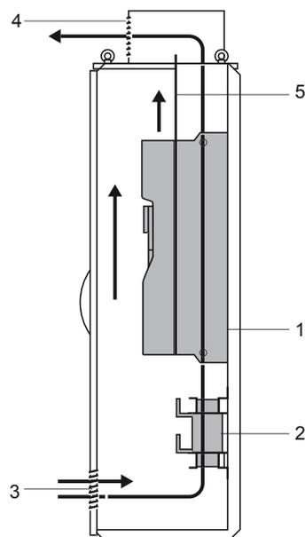
В данной конструкции шкафа охлаждающий воздух поступает через решетку в двери и выбрасывается через колпак на крыше. Встроенный вентилятор силовой части ПЧ обеспечивает циркуляцию воздуха.
