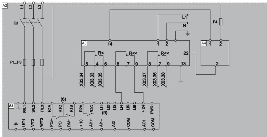
A1 ..... Преобразователь частоты ATV71
