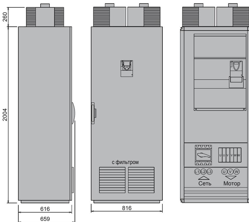
Размеры: IP54SA с отдельным контуром охлаждения
