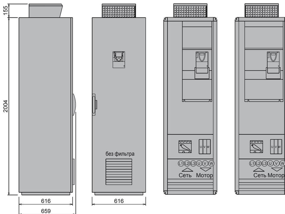
Размеры: IP54CV Компактное исполнение
