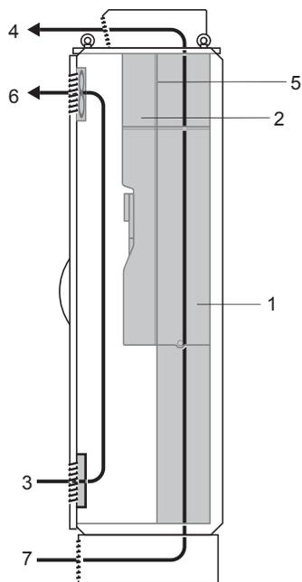
Конструкция шкафа IP54 с отдельными контурами охлаждения предусматривает забор воздуха для силовой части через цоколь шкафа и выброс через крышу шкафа. Управляющая часть охлаждается вентилятором с фильтром на двери шкафа или кондиционером (дополнительное оборудование).
