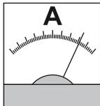
Комплект для измерения и индикации тока. Комплект поставляется в виде измерительного прибора, вмонтированного в дверь шкафа и трансформаторов тока в силовых цепях.
