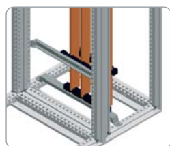
Одиночные шины на ток ≤ 1600 А (IP ≤ 31)
