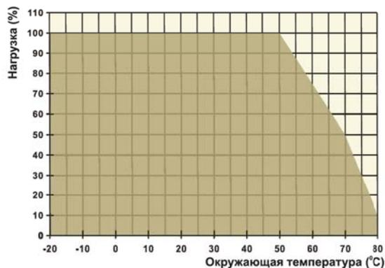
График снижения мощности PMC/PMT
