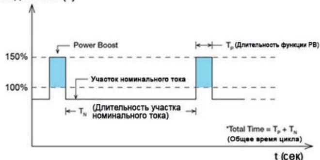
Источник питания может выдерживать перегрузки не постоянно, а в рамках рабочего цикла, состоящего из участков с номинальным выходным током и участков с повышенным выходным током. На рисунке проводится иллюстрация рабочего цикла источника питания при работе функции «Power Boost».
