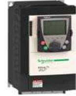
Данная серия ПЧ позволяет управлять с помощью алгоритма векторного управления потоком (CVF) асинхронными двигателями в разомкнутой и замкнутой системах регулирования скорости и синхронными двигателями с синусоидальной Э.Д.С. в разомкнутой системе. При сетевом питании а 200 - 240 В и а 380 - 480 В предлагается функциональная гамма ПЧ, позволяющая управлять синхронными двигателями с синусоидальной Э.Д.С. в замкнутой системе регулирования скорости.
